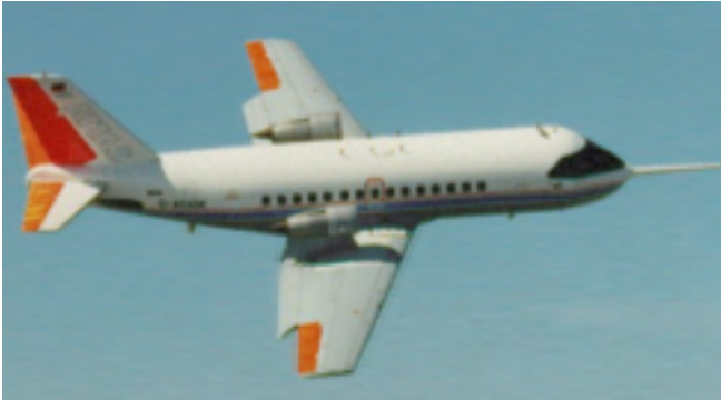
Bild 45: Fliegender Simulator ATTAS des DLR, der im Rahmen des Projektes CAMA als Versuchsträger diente.
