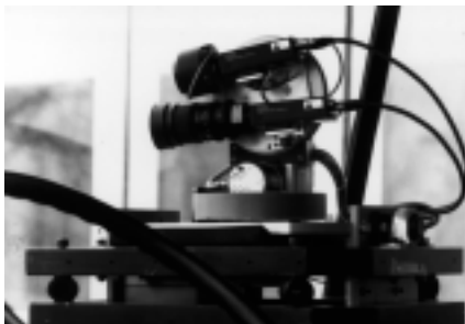
Bild 52: Erste Zweiachsen-Plattform mit Zahnriementrieb und Schrittmotoren (1984)
