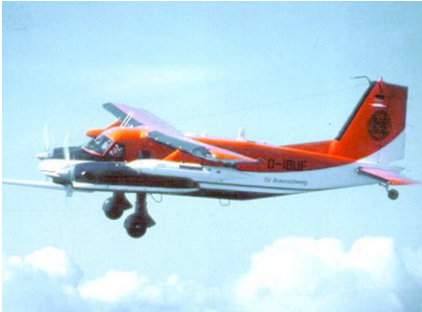
Bild 43: Weltweit erstes Testflugzeug mit der Fähigkeit zum visuellen Erkennen des Relativzustandes zur Landebahn in allen sechs Freiheitsgraden (Do-128 der TU Braunschweig mit Sehsystem der UniBwM)
