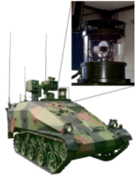
Bild 25: Kettenfahrzeug ‚Wiesel 2‘, das im Rahmen des Projektes PRIMUS-C mit einem Sehsystem der UniBwM ausgestattet wurde
