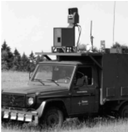
Bild 24: Geländewagen GD 300 des BMVg/Industrie-Projektes PRIMUS, der vom ISF mit einem Transputer-basierten Sehsystem mit aktiver Blickrichtungssteuerung ausgerüstet wurde
