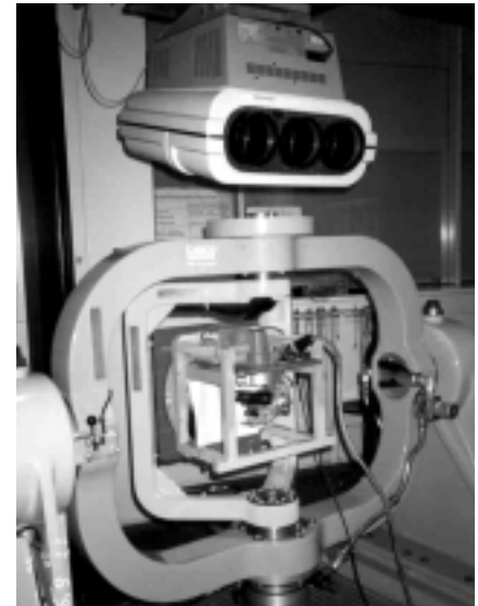
Bild 42: Der Dreiachsen-Bewegungs-Simulator (DBS) mit Videoprojektor
