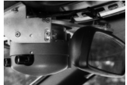
Bild 53: Gier-Plattform für PKW mit Direktantrieb und berührungsloser Messung
