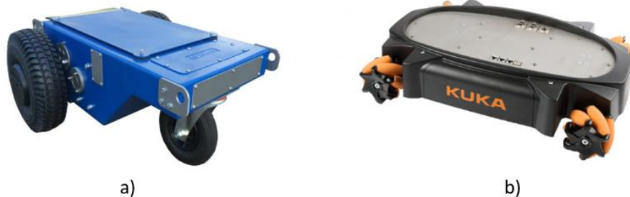
Abbildung 4-11: Beispiele rollender Roboterplattformen: a) 2 WD Max (Werkbild UlrichC), b) YouBot (Werkbild KUKA)
