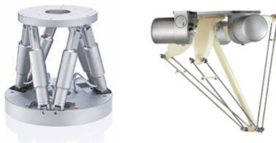
Abbildung 4-3: Links: Hexapod PI-HexAntenna, rechts: Delta-Roboter Autonox 24 [Weber u. Koch, 2022]
