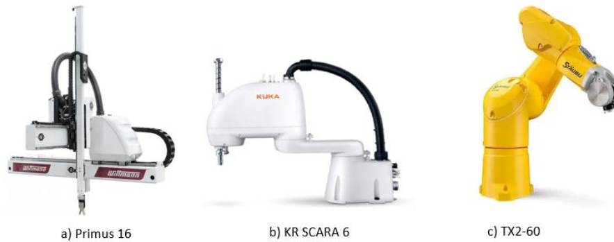
Abbildung 4-2: a) Kartesischer Roboter Primus 16 (Werkbild Wittmann), b) Horizontal-Knickarmroboter KR SCARA 6 (Werkbild KUKA), c) Gelenkroboter TX2-60 (Werkbild Sträubli Robotics)
