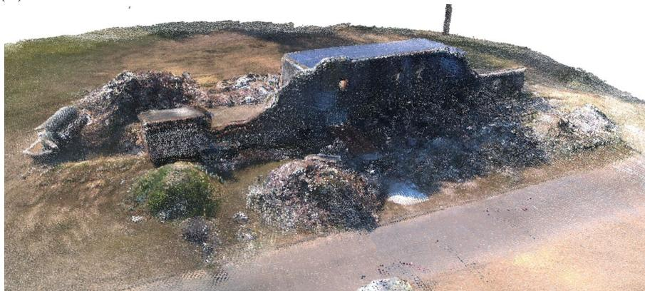
**Abbildung 2.6:** Luftgestützte LiDAR-Punktwolke: (a) Ohne Farbinformationen. (b) Mit Farbinformationen aus Drohnenbildern.
