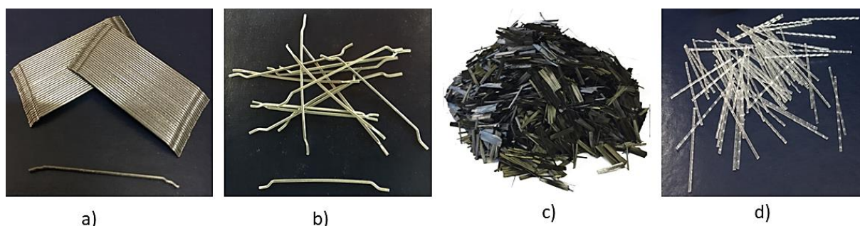
Abbildung 2-11: Fasertypen- Stahlfasern: a) Dramix 4D und b) KrampeHarex, c) Carbonfasern und d) PP-Fasern.
