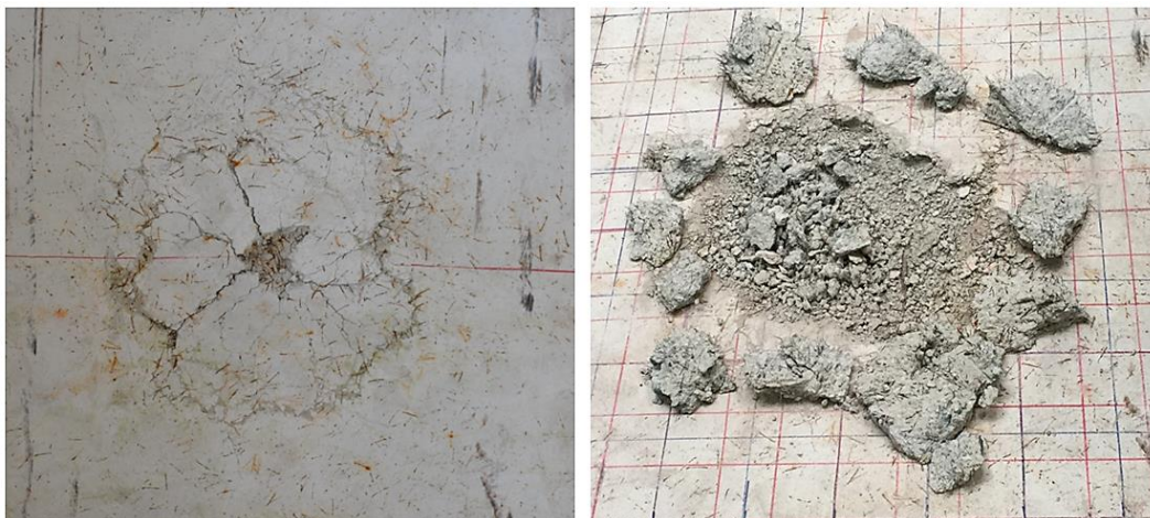
Abbildung 6-8: Bestimmung der Kraterabmessungen der Platte für die Schadenskategorie III.
