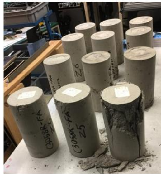
Betonproben aus der Plattenherstellung
