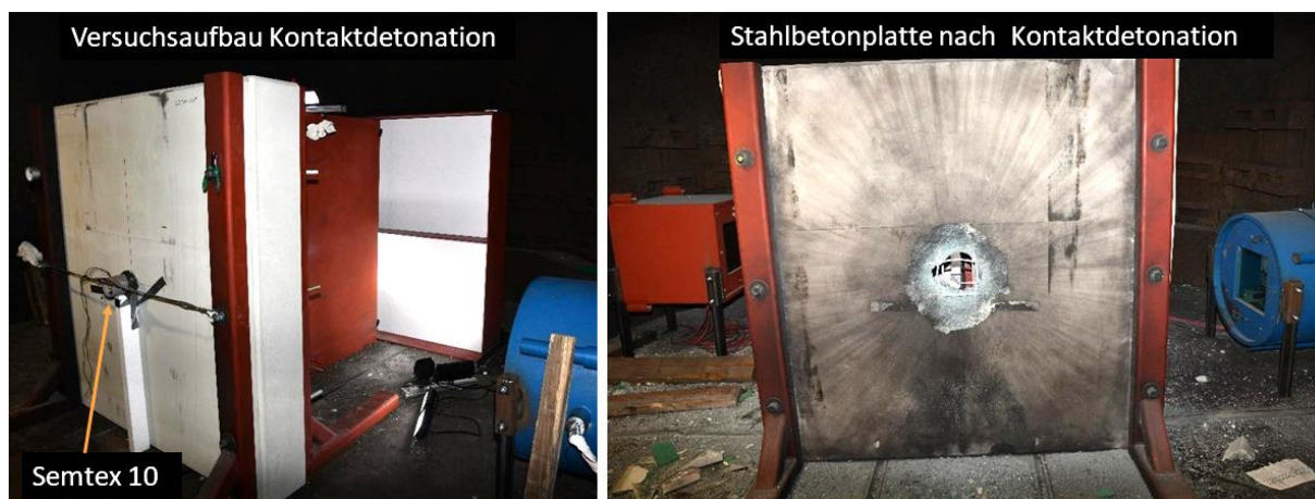
Abbildung 4-5: Versuchsaufbau Kontakt detonation (Stahlbetonplatte vor- und nach Detonation).
