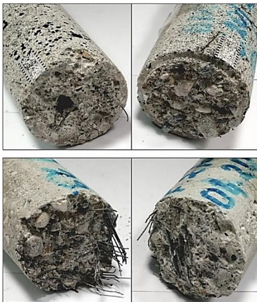
Abbildung 2-19: Vergleich der Bruchflächen zweier stahlfaserbewehrter Proben (2,0 Vol.-%) [108].
