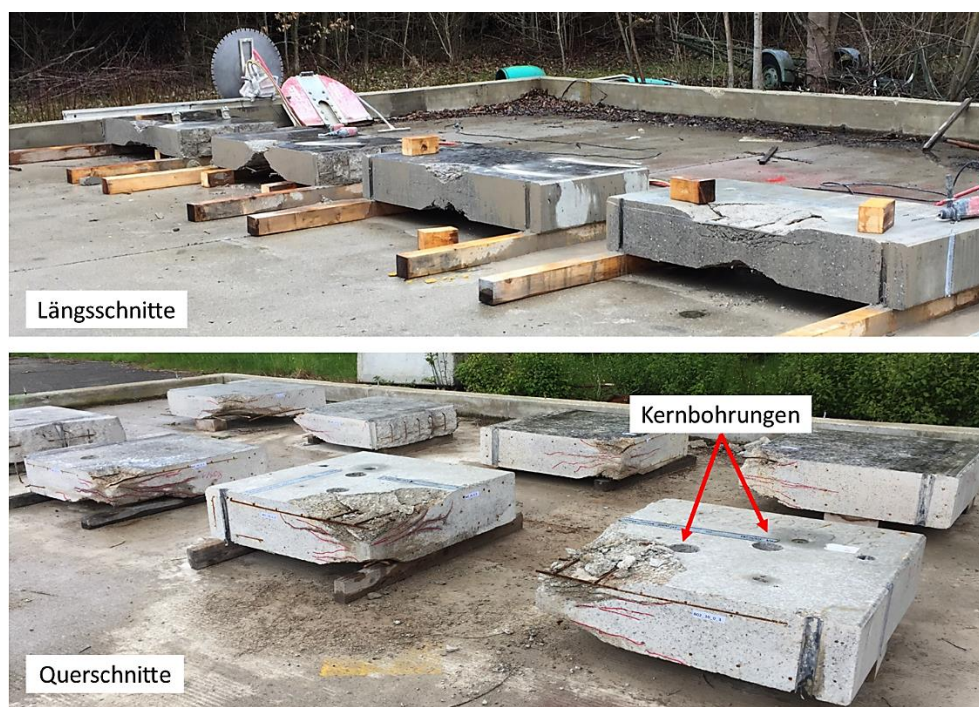
Abbildung 5-58: Zerstörende Prüfung der Platten (Zersägen/ Trennen).
