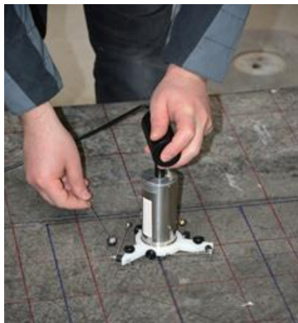
Abbildung 5-23: Durchführung der manuellen Anregung mittels Stahlkugel.
