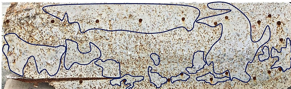
Abbildung 5-68: Faserverteilung im Querschnitt einer durchtrennten Platte.
