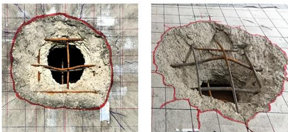
Abbildung 5-6: Beispieldarstellung Schadenskategorie I, Beanspruchungsseite (links) Schutzseite (rechts), Platte S-20-0-2.
