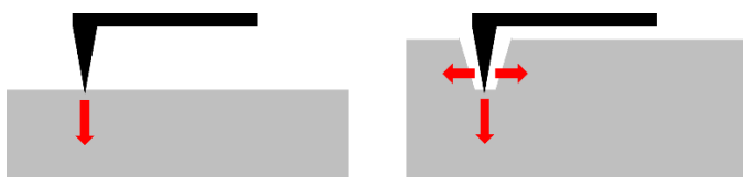
Abbildung 44 Schematische Darstellung des Wärmeabflusses von einer AFM-Spitze auf einer Probe. Links: Probe mit geringer Oberflächenrauheit und ohne topographische Merkmale, Rechts: Probe mit ausgeprägten topographischen Merkmalen.
