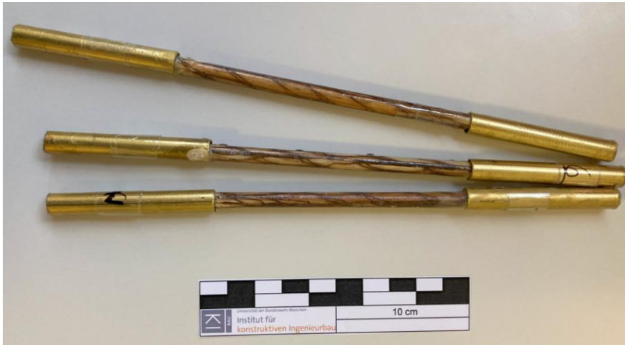
Abbildung 9 – Vorbereitete Proben für die Zugversuche der Hanfbastbewehrungsstäbe mit beidseitig geklebten Einspannhülsen
