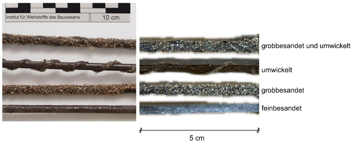
Abbildung 10 – profilierte Hanfbastbewehrungsstäbe mit sechs Millimeter Durchmesser (von oben nach unten: „besandet + umwickelt“, „umwickelt“, „grob besandet“, „fein besandet“)
