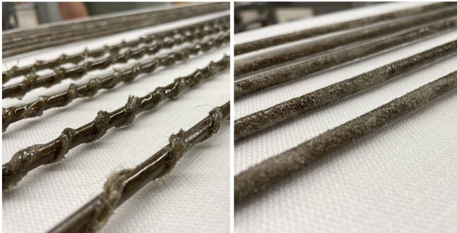
Abbildung 15 – profilierte Bewehrungsstäbe der Balkendemonstratoren (links: Stäbe mit „Umwicklung“, rechts: „besandete“ Stäbe)
