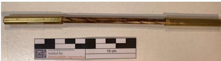
Abbildung 26 – Versagte Zugprobe eines Hanfbastbewehrungsstabes
