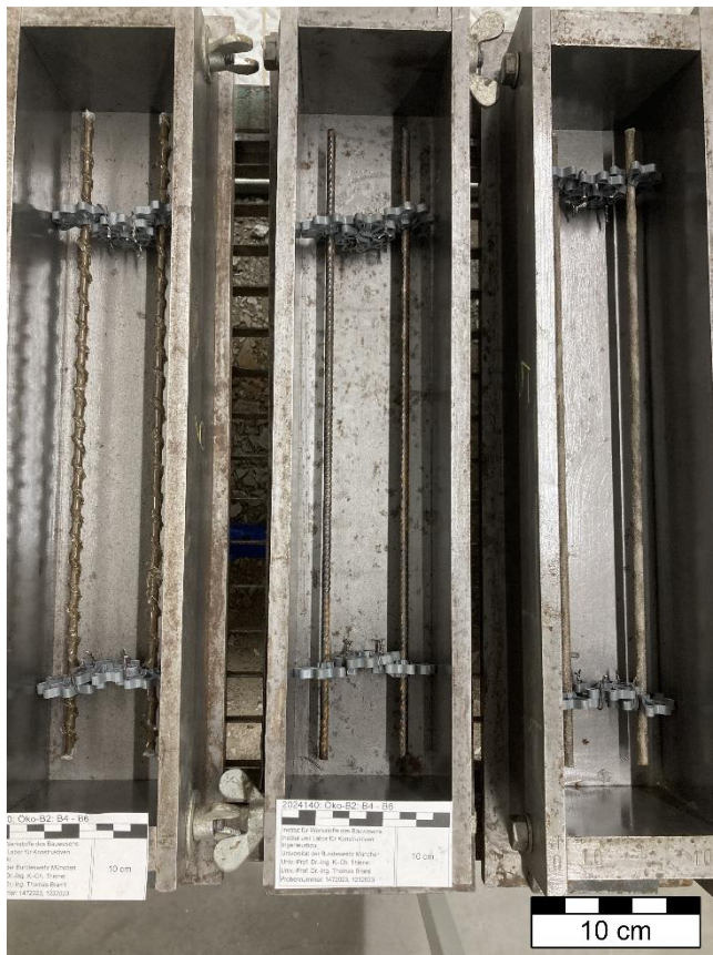
Abbildung 51 – vorbereitete Schalung der Probekörper ÖkoB2 mit Proben B4 „unwickeltem“ Hanfbastbewehrungsstab (links), B5 „besandedem“ Hanfbastbewehrungsstab (rechts) und B6 Ø 6 mm Betonstahl Referenz (mittig) Probekörper ÖkoB1 Proben B1 bis B3 analog
