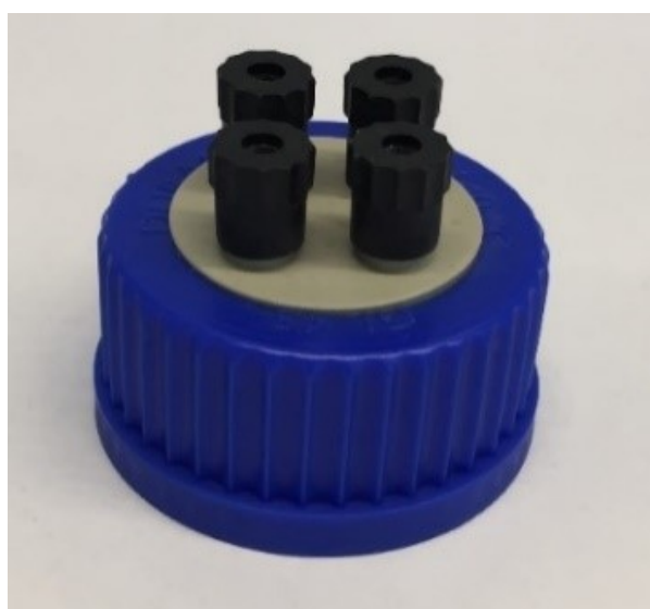
Abbildung 97. 100 mL Gewindeflasche (links) und Flaschen-Mehrfachverteiler mit vier Anschlüssen (rechts).
