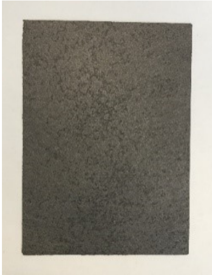
Abbildung 93. Gasdiffusionsschicht aus Kohlepapier GDS090S der Firma QuinTech.
