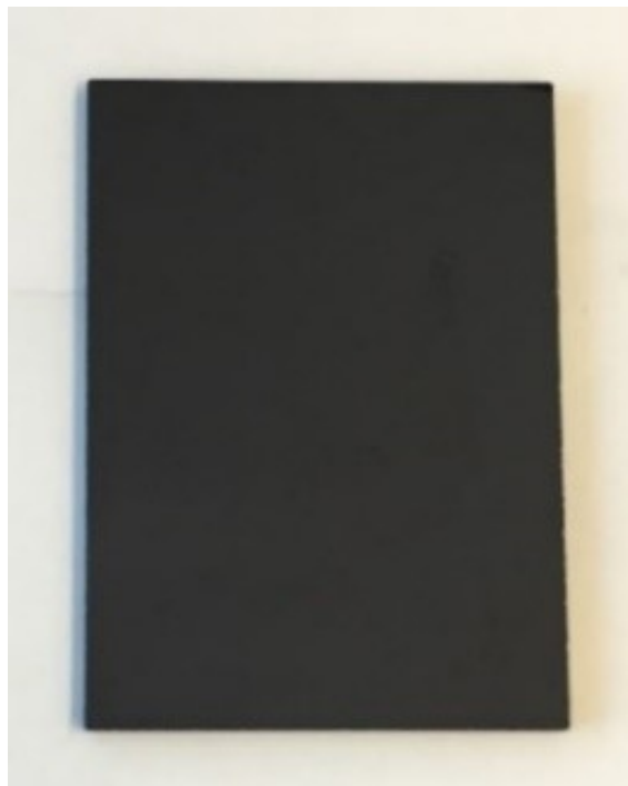
Abbildung 94. Bipolarplatte aus Glaskohlenstoffwerkstoff SIGRADUR G der Firma HTW Hochtemperatur-Werkstoffe GmbH.
