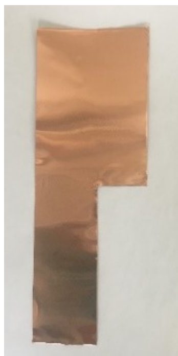
Abbildung 92. Kupferband für den elektrischen Kontakt zwischen Zelle und Messgerät.
