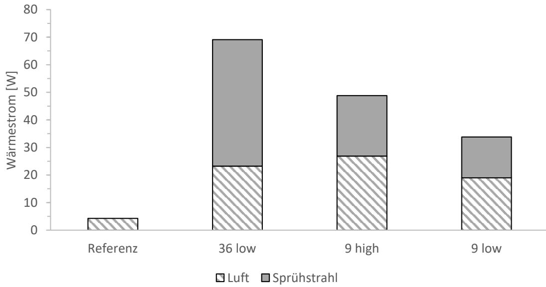
(a) Wärmestrombilanz am Wickelkopf pro Variante
