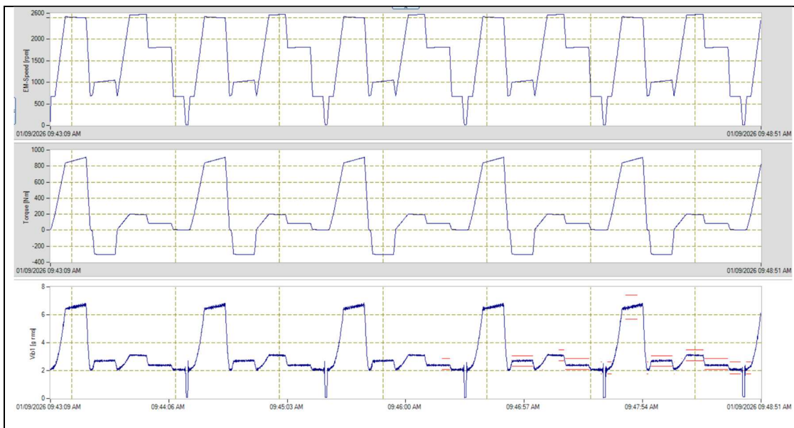
Abb. 7: Verlauf der ersten fünf Prüfzyklen. Von oben nach unten dargestellt: Antriebsdrehzahl, Antriebsmoment sowie Körperschallsignal (blau: berechnet als Kurzzeiteffektivwert, rot: obere und untere Grenzwerte, ermittelt mittels maschinellen Lernens).
