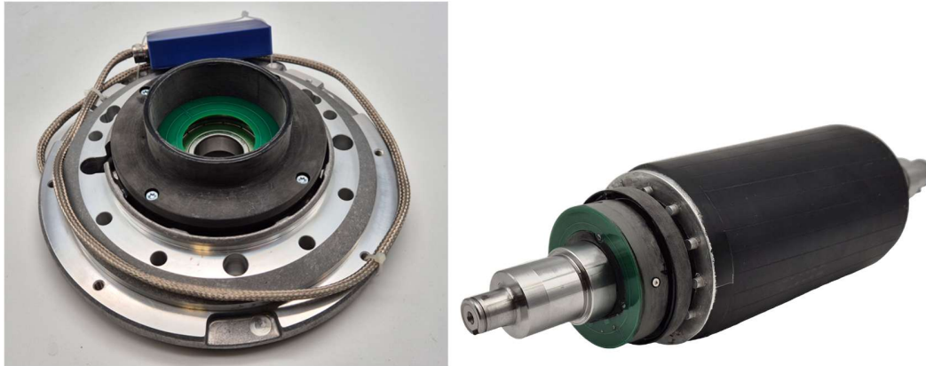
Abb. 3: Messaufbau für einen Prüfstand, Drehmoment und Temperaturmessung integriert in einen Elektromotor
