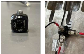
Abb. 4: Montagewürfels 030 (rechts), KS78C.100 Beschleunigungssensoren in (x-, y-, z-Richtung) auf dem Montagewürfels 030 auf dem Magnesium-Gleittisch montiert (rechts)
