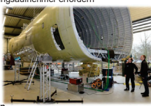
Beispiel DLR: Airbus-Rumpf, Umlieg von Beschleunigungssensoren auf Scanning LDV
