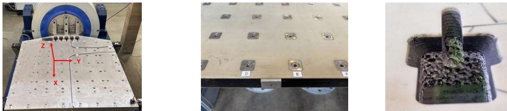
Abb. 2: Magnesium-Gleittisch mit direkt ins Material eingebrachten M8 Gewinden Koordinatensystemdefinition (links), als ein Ausschnitt des Aluminium-Karbon-Gleittisches mit integrierten M8 Gewindehülsen (Mitte) und einer gefrästen Tasche mit Querschnitt des Schichtaufbaus (rechts)
