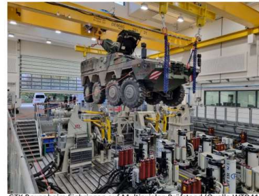
GTK Boxer beim Einbringen auf Multiaxialen Prüfstand (Quelle WTD41)
