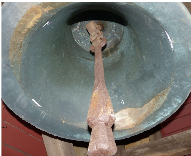
Abb. 10: Glocke 2 von Thierrens mit starkem Verschleiß am Schlagring
