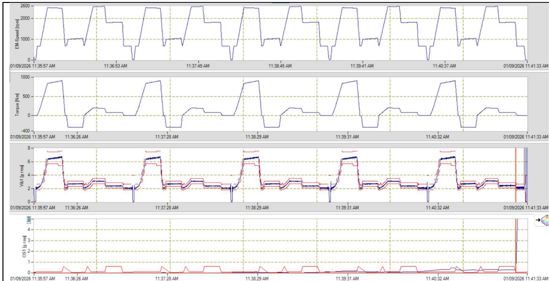
Abb. 11: Die letzten fünf Zyklen vor der Abschaltung. Von oben nach unten dargestellt: Antriebsdrehzahl, Antriebsmoment, Körperschallsignal sowie der Indikator „Abweichung aus dem Ordnungsspektrum“.
