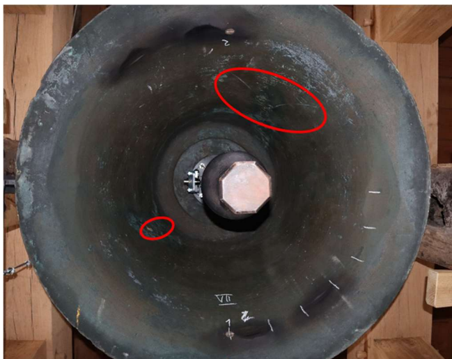
Abb. 11: Glocke 7 (links) mit Flankenrissen (rechts)
