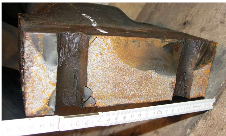
Abb. 12: Klöppelseitige Bruchfläche mit Kerben in Bohrungen
