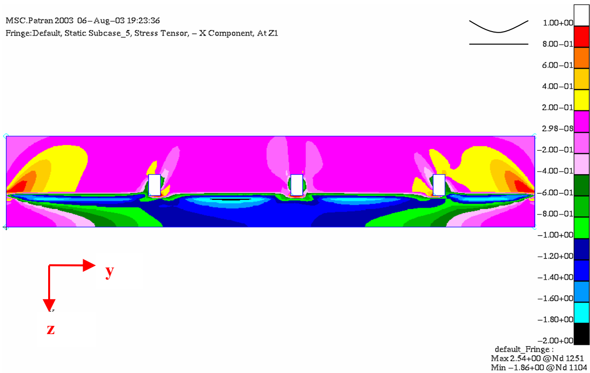
SA2.4.-02: Spannung \sigma_y , Beispiel 1, mit Entlastungsnuten
