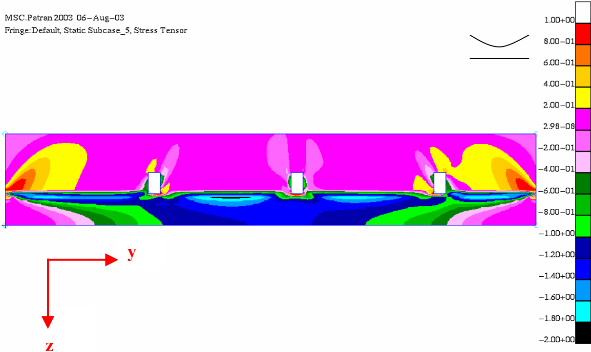
S4.1.-01: Spannung \sigma_y im einzelnen „Brett“ im lokalen Koordinatensystem gemäß F4.1.-04
