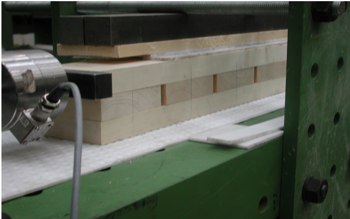
F3.2.-03: Versuchsaufbau für Brettlagenholz mit nachgiebigen Verbund mit Seite A / Seite AB
