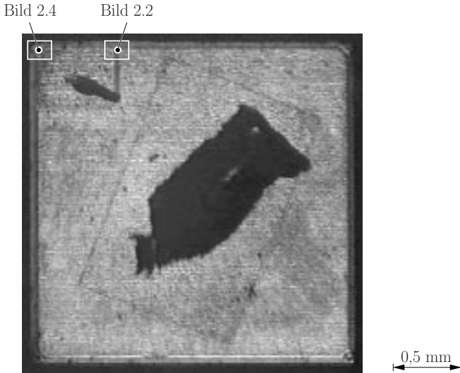
Bild 2.6: Gesamt-Chip mit Bonddrahtresten
