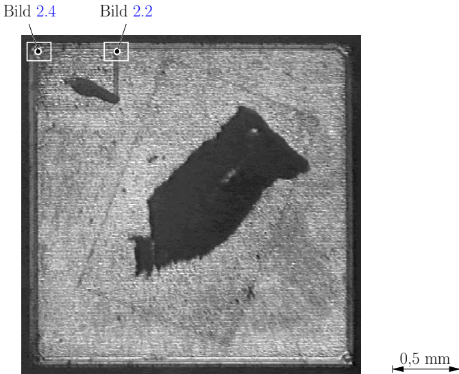
Bild 2.6: Gesamt-Chip mit Bonddrahtresten
