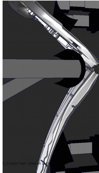
Abbildung 6-14: Qualitativer Vergleich des Versuchs mit der Simulation mit Berücksichtigung des Diskretisierungsfehlers anhand Einzelbilder der Hochgeschwindigkeitsfilmaufnahmen und Deformationsbilder aus dem Simulationsmodell – Draufsicht (Teil 3); t=40 ms.
