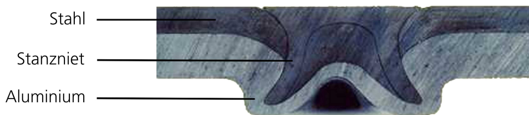
Abbildung 1-4: Schnitt durch eine Stanznietverbindung von Stahl und Aluminium. Die große Verformung aller Verbindungspartner und das gezielte Versagen des oberen Bleches sind sichtbar [50].
