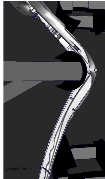
Abbildung 6-17: Qualitativer Vergleich des Versuchs mit der Simulation ohne Berücksichtigung des Diskretisierungsfehlers anhand Einzelbilder der Hochgeschwindigkeitsfilmaufnahmen und Deformationsbilder aus dem Simulationsmodell – Draufsicht (Teil 3); t=40 ms.
