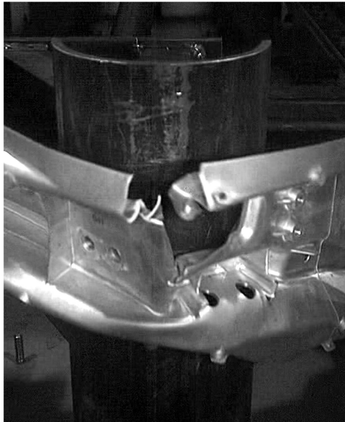
Abbildung 6-11: Qualitativer Vergleich des Versuchs mit der Simulation ohne Berücksichtigung des Diskretisierungsfehlers anhand Einzelbilder der Hochgeschwindigkeitsfilmaufnahmen und Deformationsbilder aus dem Simulationsmodell – Rückansicht (Teil 3); t=40 ms.
