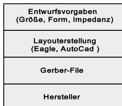
Bild 5.1: Arbeitsschritte bei der Planarspulenherstellung
