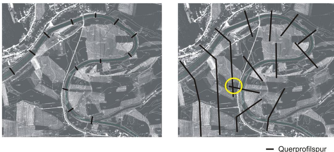
**Abb. 5.2:** Abbildung des Flussgerinnes mittels Querprofilen. Links: Abfluss über den Flussschlauch (*kompaktes Gerinne*). Rechts: Abfluss über Flussschlauch und Vorland (*gegliedertes Gerinne*)
