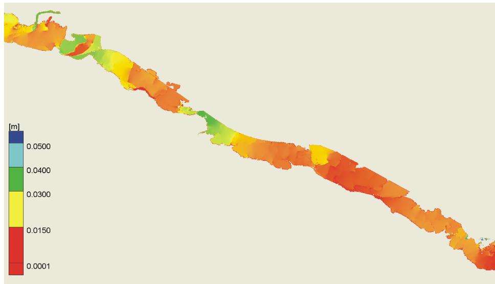
**Abb. C.27:** Differenz der maximalen Wassertiefen für einen stationären und instationären Abfluss der Jährlichkeit 100 für mittlere Parameterwerte, 2D Modell
