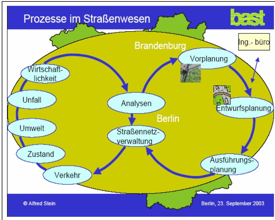
Abb. 2-12: Prozesskreisläufe im Straßenwesen [69]
