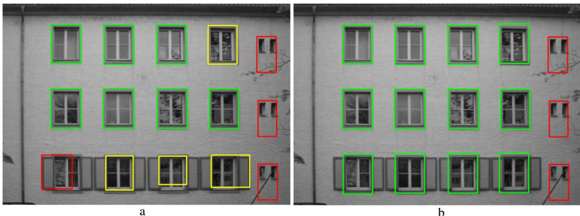
Abbildung 7.11: a) Ergebnis vor der Validierung der Objekte; b) Endgültiges Ergebnis.
