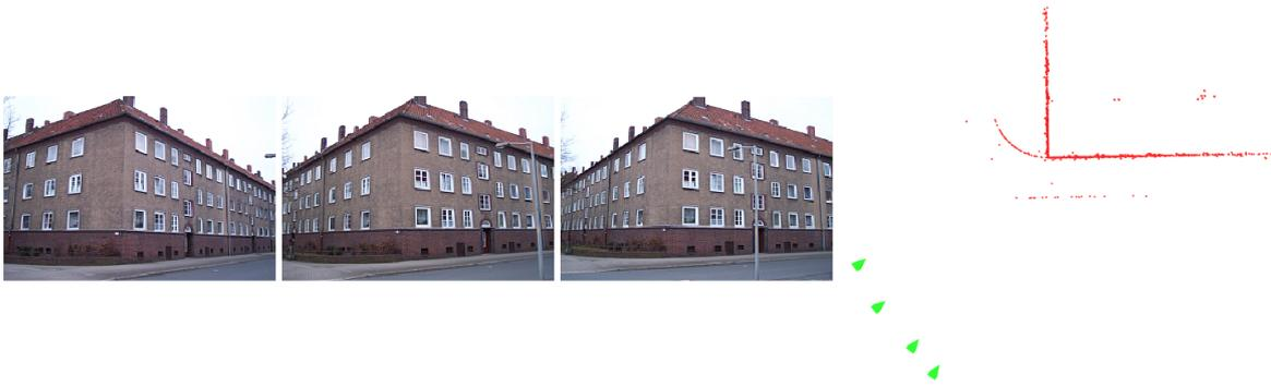
Abbildung 4.3: *Drei von vier Bildern der Wide-Baseline Bildsequenz und euklidische Rekonstruktion (Punkte in rot, Kameras als grüne Pyramiden).*
