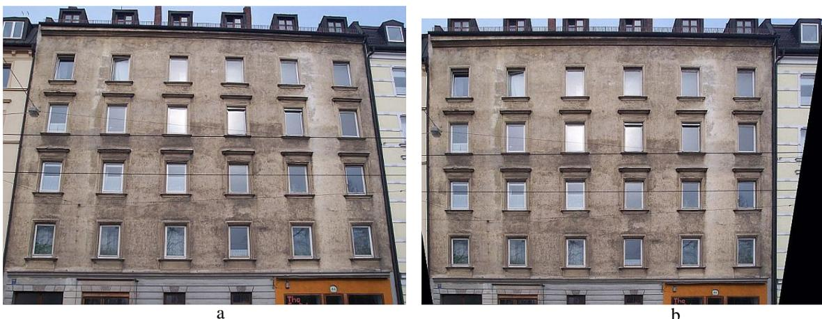
Abbildung 5.2: a) Originalaufnahme einer Fassade; b) Orthogonalisiertes Bild.
