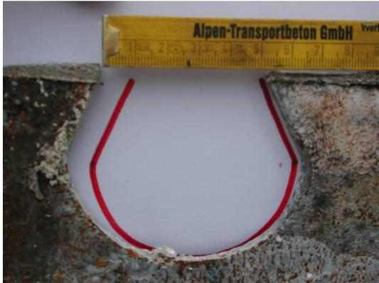
Bild 5.52: Stahldeformation des zweiten Außendübels.
