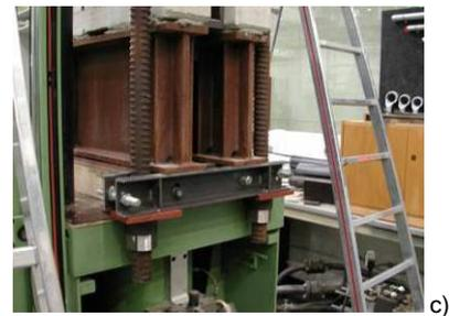
Bild 5.118: a) Push-Out-Körper im Versuchsstand für zyklische Wechselbeanspruchung; b) Details oben; c) Details unten.
