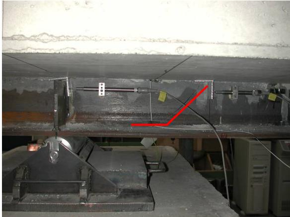
Bild 5.22: Rissverlauf ET1 am zweiten Dübel (erster Dübel über dem Auflager).
