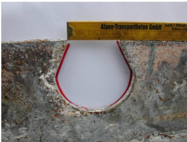
Bild 6.33: Dübeldeformation am aufgesägtem Prüfkörper.
