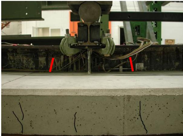
Bild 5.75: Rissverlauf im Steg von ET4b.
