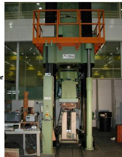
Bild 5.120: Überprüfung des Resttragvermögens.
