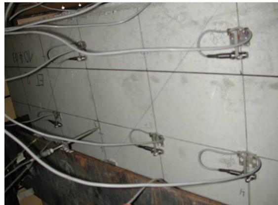
Bild 5.7: Induktive Wegaufnehmer am Betongurt ET2 (unten).
