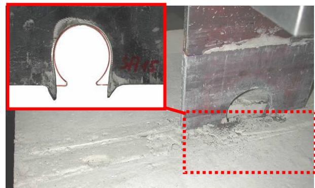
Bild 5.193: Versagenstyp Stahlauszug eines offenen Betondübel.
