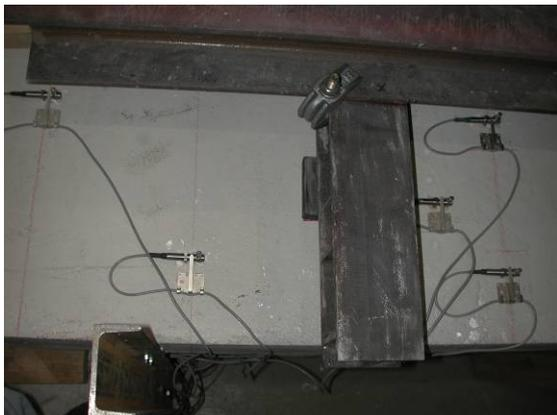
Bild 5.6: Induktive Wegaufnehmer am Betongurt ET2 (oben).
