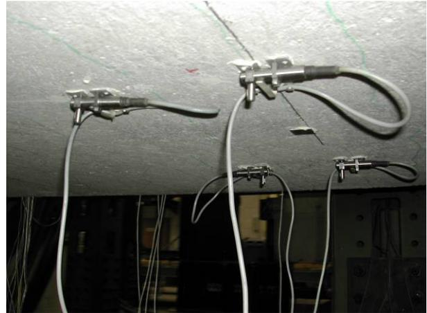
Bild 5.102: Verzerrungsmessung an der Unterseite.
