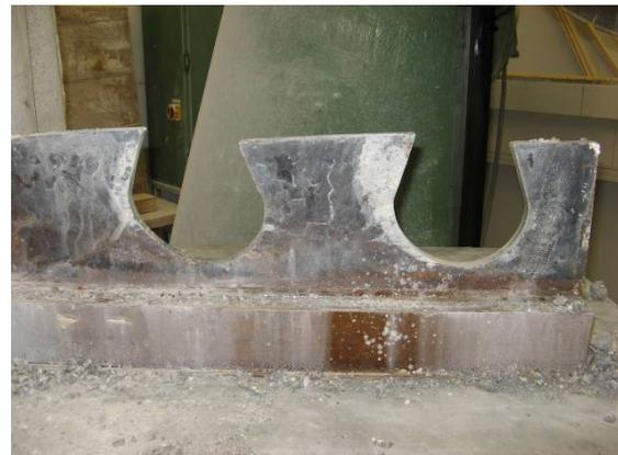
Bild 5.167: Freigelegter Baustahl von ED6-K1.
