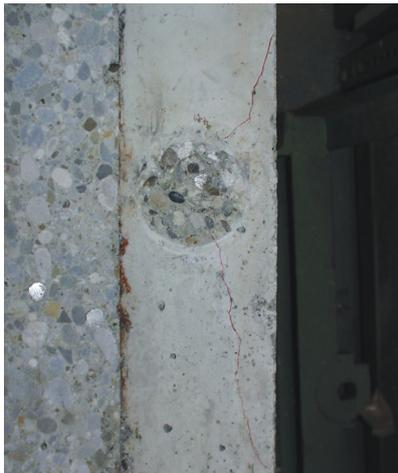
Bild 2.9: Ausbruchkegel am zerlegten Versuchskörper /2/.
