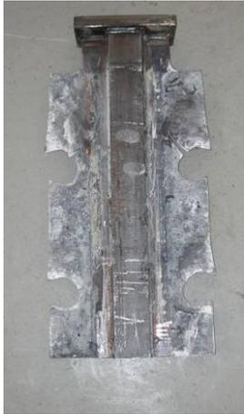
Bild 5.146: Risse im Stegblech von ED3-K3.
