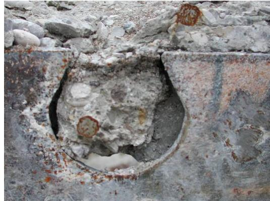
Bild 5.53: Betongefüge des zweiten Außendübels.
