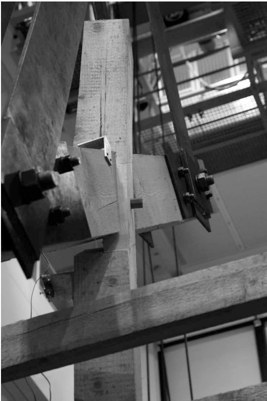
Abb. 4.20: Probe 04: Rotation des vertikalen Balkens (Versagensmodus 1)
