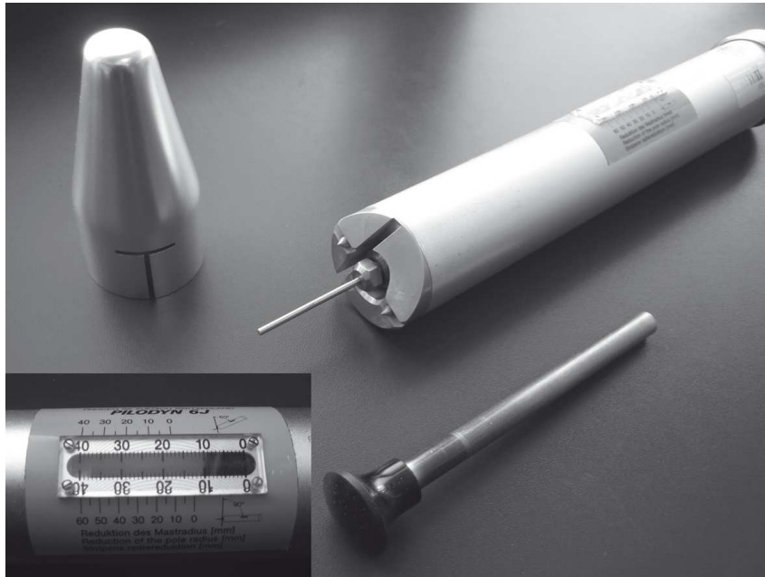
Abb. 3.14: Für eigene Dichtermittlungen verwendetes Gerät: Pi-lodyn 6J
