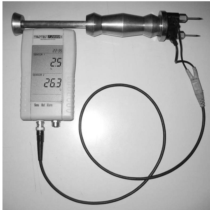
Abb. 3.6: Für eigene Messungen verwendetes Gerät: TS 70 Ramm-Elektrode mit T2000 Messgerät
