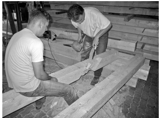
Abb. 4.5: Zimmermannsmäßige Ausarbeitung einer Überblattung
