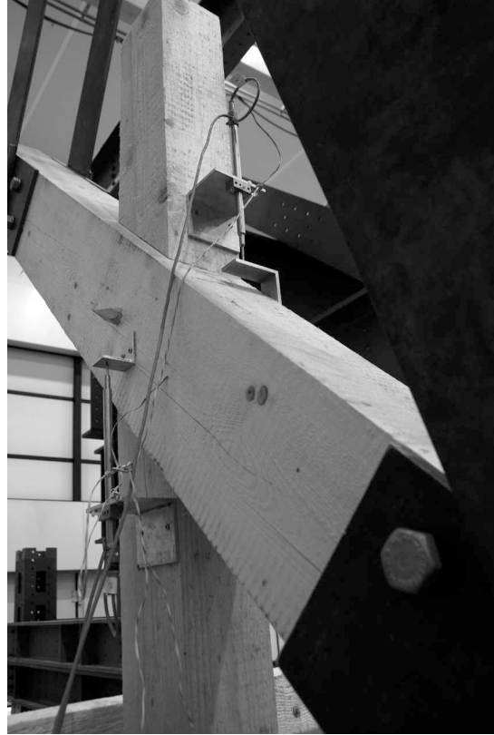
Abb. 4.16: Instrumentierung von Probekörper 06
