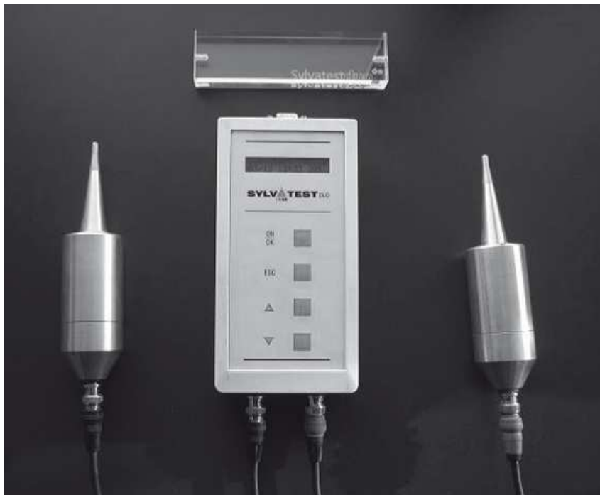
Abb. 3.15: Für eigene Messungen verwendetes Gerät: Sylvatest-DUO mit Konusschallköpfen und Plexiglas-Prüfkörper
