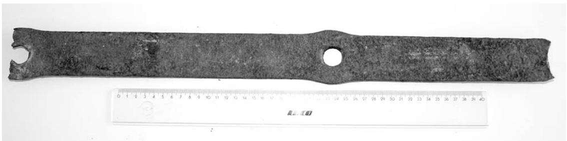
Abb. 3.19: Eisenband aus dem Dachwerk der Klosterkirche Fürstenfeldbruck zur Bestimmung der Zugfestigkeit, Streckgrenze, Bruchdehnung und chemischen Zusammensetzung
