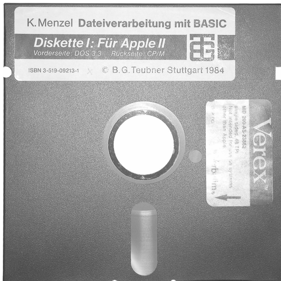
Abbildung 4: Eine aufgebohrte Diskette (single sided laut Label des Herstellers) mit zusätzlicher Schreibschutzkerbe links oben für das zweiseitige Schreiben
