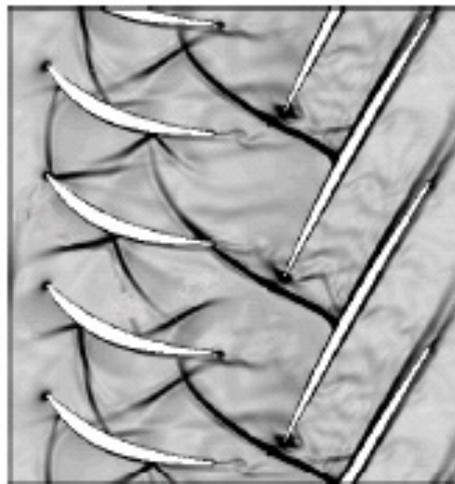
Abb. 2.7: Rotor-Stator-Interaktion bei transsonischen Strömungsbedingungen (Zachcial und Nürnberg [101])
