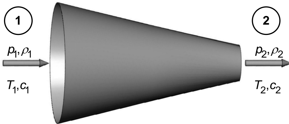
Abbildung 5.1 Darstellung des Kontrollraumes 1-2 einer isentropen Düsenströmung
