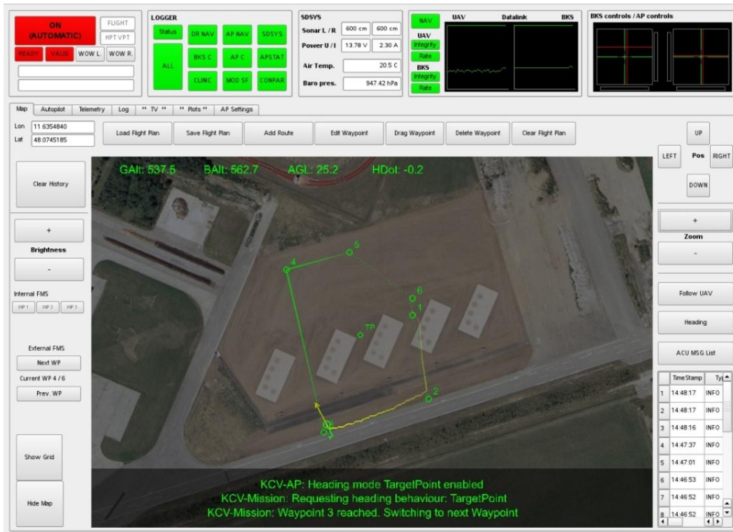
Abbildung 6-7. Anzeige von Nachrichten der KCV-ACU im Map-Display des BKS TermIO-Prozesses
