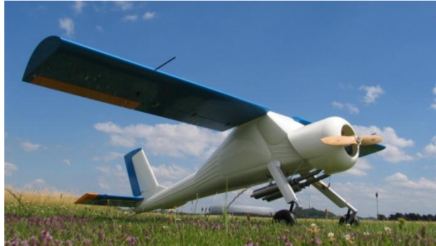
Abbildung 2-3. UAV Forschungsdemonstrator der Universität der Bundeswehr München (UniBwM) auf Basis eines Modellflugzeugs.
