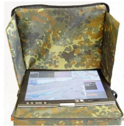
Abbildung 2-8. Links: Arbeitsplätze innerhalb der Bodenkontrollstation für das System Predator (Bild von General Atomics Aeronautical Systems [General Atomics Aeronautical Systems, Inc., 2011]) Rechts: Tragbare Bodenkontrollstation für das System Aladin (Bild von EMT Penzberg [EMT Ingenieurgesellschaft, 2009])
