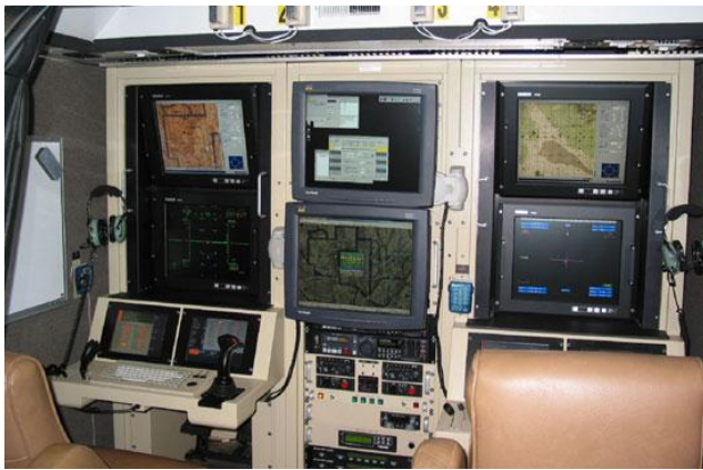
Abbildung 2-8. Links: Arbeitsplätze innerhalb der Bodenkontrollstation für das System Predator (Bild von General Atomics Aeronautical Systems [General Atomics Aeronautical Systems, Inc., 2011]) Rechts: Tragbare Bodenkontrollstation für das System Aladin (Bild von EMT Penzberg [EMT Ingenieurgesellschaft, 2009])
