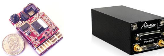
Abbildung 2-4. Kommerzielle Autopilotensysteme: Links der Kestrel Autopilot der Firma Procerus [Procerus Technologies, 2010]; Rechts das System Piccolo II der Firma Cloudcap Technologies [Cloud Cap Technologies, 2006]
