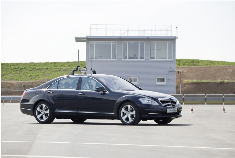
Abbildung 5.10 – Roboterfahrzeug, mit dem vorgegebene Trajektorien sehr genau abgefahren und aufgezeichnet werden können.
