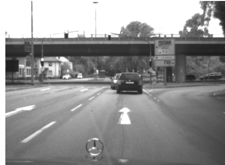
Abbildung 6.5 – Sequenz Nr. 1: Die Höhe wird während der Annäherung an die Brücke mit einem mittleren Fehler von 0,25 m geschätzt.
