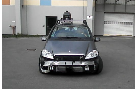
Abbildung 6.21 – Versuchsträger zur Evaluierung der Parklückenvermessung.
