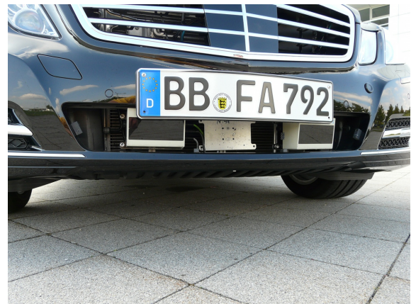
(b) Zwei SICK LD-MRS im unteren Bereich der Stoßstange
