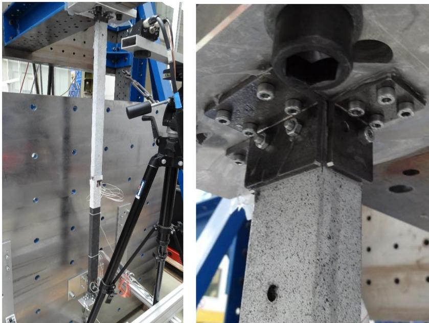
Abbildung 62: Versuchsaufbau des statischen Versuch
