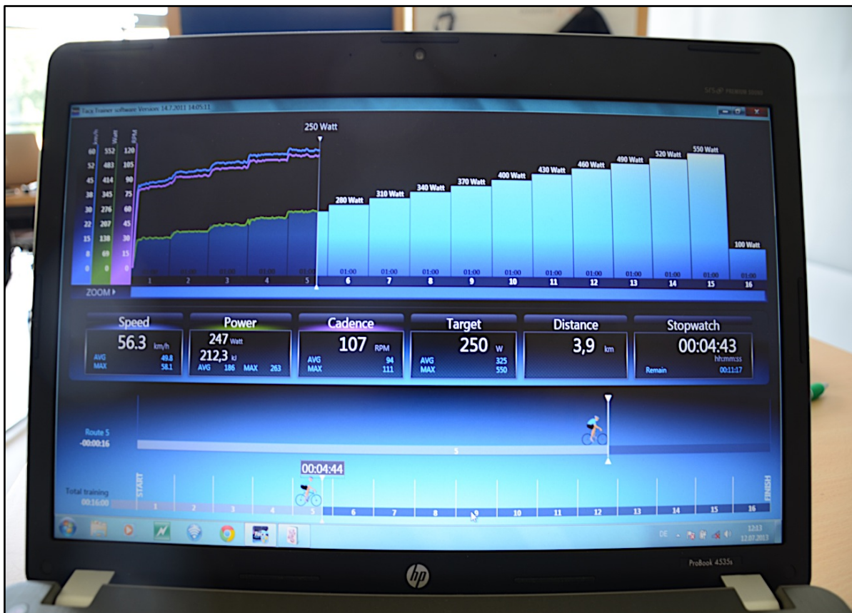
Abbildung 23. Darstellung des Bildschirms während der Testphase eines Rampentests auf dem Fahrradergometer.
