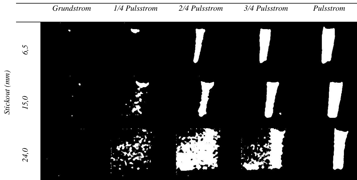
Abbildung 4–14: Typische Metaldampfentstehung als Funktion des Stickouts und des Schweißstroms
